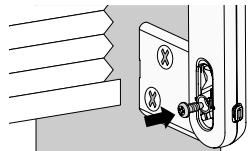
8. Asegúrese de que la cadena de cuentas pueda moverse libremente a través del UCT sin engancharse en el cierre. El centro del orificio del tornillo debe estar alineado con la muesca del UCT ( $\pm\frac{1}{8}$ ").
