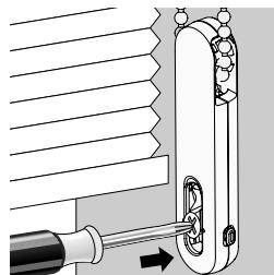
**PRECAUCIÓN:** No apriete demasiado el tornillo de montaje. Esto puede impedir que el UCT funcione correctamente y aumentar el desgaste de la cadena de cuentas de cuntas.
