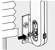
8. Asegúrese de que la cadena de cuentas pueda moverse libremente a través del UCT sin engancharse en el cierre. El centro del orificio del tornillo debe estar alineado con la muesca del UCT ( $\pm 1/8"$ ).
