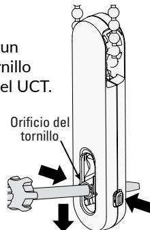
2. Mientras presiona los botones de liberación del UCT situados a los lados del UCT, mueva el orificio del tornillo hacia abajo para liberar el mecanismo de seguridad.
