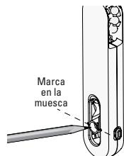
4. Sujete el soporte OB con el orificio central alineado con la marca y marque la posición de los dos orificios para los tornillos.
