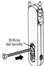
c. Presione los botones de liberación del UCT y tire hacia abajo del orificio del tornillo para alinear el orificio con el anclaje de pared o el orificio guía.
